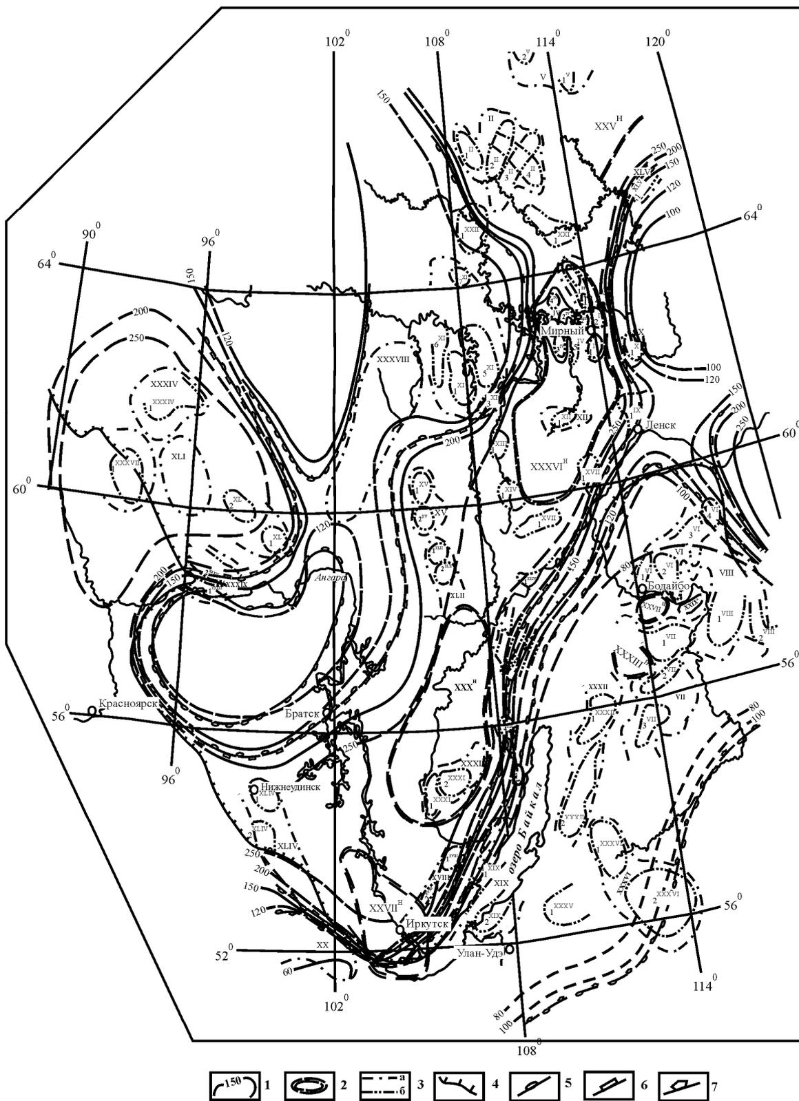
1 - изоглубины до поверхности астеносферы; 2 - контуры непроводящих геоэлектрических неоднородностей; 3 - контуры проводящих геоэлектрических неоднородностей; а - первого порядка; б - второго порядка; 4 - граница Сибирской платформы (схематично); Предполагаемые контуры провинций: 5 - железорудной; 6- кимберлитовой; 7 - редкометально-золоторудной
